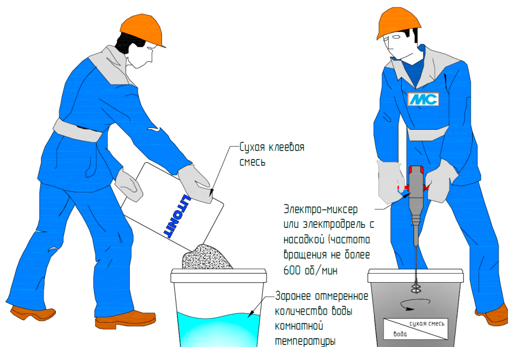
Рис. 30. Организация работ по затворению сухой клеевой смеси
